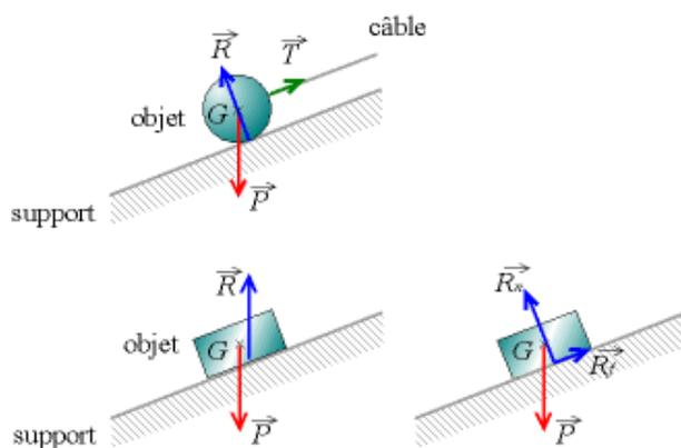
FIGURE 3.8 – Équilibre des forces : réaction du support sans frottement (en haut) et avec frottement statique (en bas).
