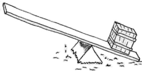
FIGURE 3.15 – Illustration du principe du levier.
