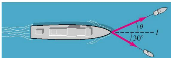
Deux remorqueurs amènent un navire dans un port. Le remorqueur le plus puissant génère une force de  $16000 \text{ N}$ . Le navire suit une ligne droite  $l$ . Calculer l'angle que forme le plus puissant remorqueur avec la droite  $l$ .
