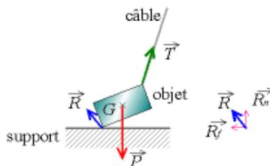
FIGURE 3.9 – Exemple de réaction du support non perpendiculaire à la surface. La réaction  $R$  se décompose en une composante normale  $R_n$  et une composante frottement statique  $R_f$ .
