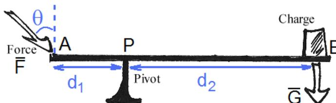
Le dispositif ci-dessus présente les dimensions suivantes :  $d_1 = 20 \text{ cm}$ ,  $d_2 = 65 \text{ cm}$ . Le poids  $\vec{G}$  de la charge vaut  $50 \text{ N}$  et la force  $\|\vec{F}\| = 350 \text{ N}$ .
