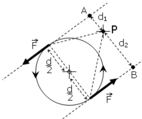
FIGURE 3.14 – Couple de forces :  $\|\vec{C}\| = \|\vec{F}\| d_1 + \|\vec{F}\| d_2 = \|\vec{F}\| (d_1 + d_2) = \|\vec{F}\| d$ . Le couple de forces est indépendant du pivot  $P$  considéré.
