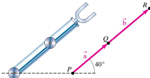
La figure ci-dessus représente le bras d'un robot. Ce bras peut pivoter aux articulations  $P$  et  $Q$ . Le bras supérieur (représenté par  $\vec{a}$ ) fait  $37,5 \text{ cm}$  de long et l'avant-bras, y compris la main (représenté par  $\vec{b}$ ), a une longueur de  $42,5 \text{ cm}$ . Calculer les coordonnées du point  $R$  situé sur la main.
