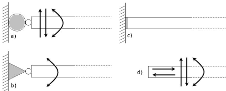
FIGURE 3.4 – a) Rouleau : 1 translation et 1 rotation (2 degrés de liberté). b) Charnière : 1 rotation (1 degré de liberté). c) Liaison fixe : aucun mouvement possible (0 degrés de liberté). d) pas de liaison : 2 translations et 1 rotation (3 degrés de liberté).
