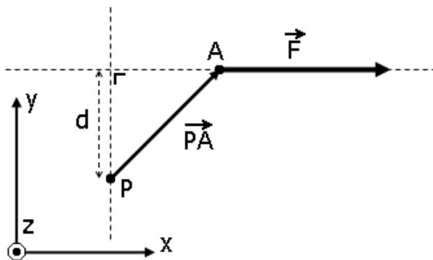
FIGURE 3.12 – Le bras de levier  $d$  est la distance qui sépare la droite de glissement de la force appliquée  $\vec{F}$  au pivot  $P$ .
