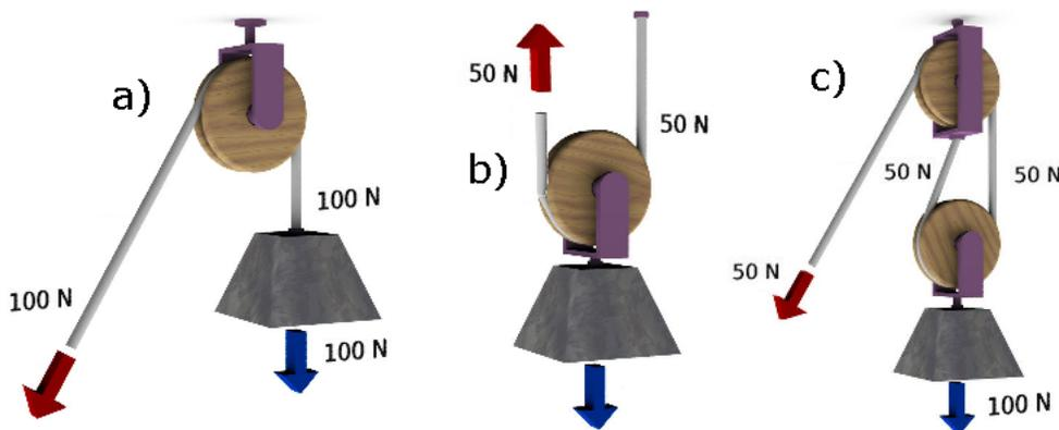
FIGURE 3.19 – a) Poulie simple fixe : la force change de sens. b) Poulie simple mobile : la force transmise est divisée par 2. c) Poulies composées : la force transmise est divisée par deux et change de sens.
