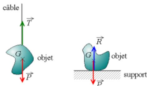
FIGURE 3.6 – Equilibre des forces : exemples de la masse suspendue à un câble (à gauche) et de la masse posée sur un support (à droite)
