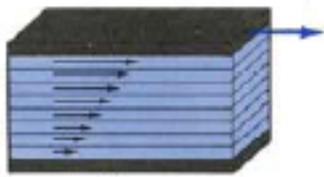
FIGURE 2.1 – Écoulement laminaire pour un fluide visqueux : déplacement d'un élément de fluide.
