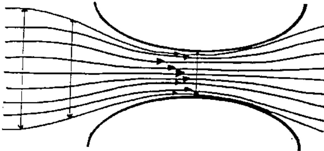
FIGURE 1.6 – Écoulement laminaire : lignes de courant
