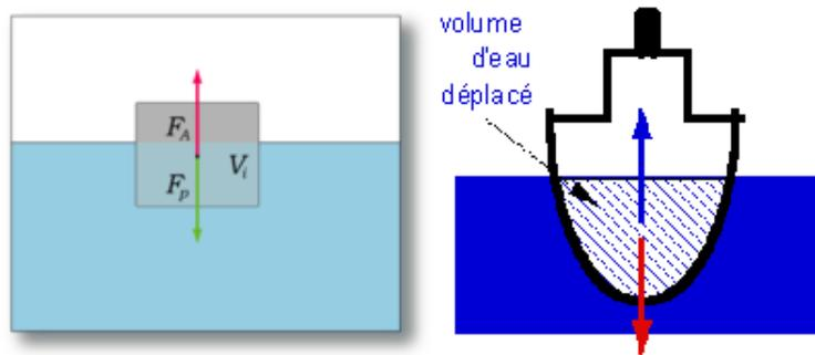
FIGURE 1.3 – Solide flottant à la surface d'un liquide
