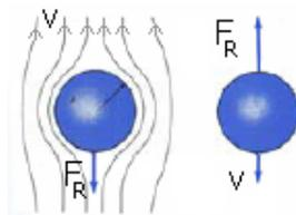
FIGURE 2.4 – Force résistante ; à gauche, le fluide se déplace autour de la sphère au repos et à droite, la sphère se déplace dans le fluide au repos.
