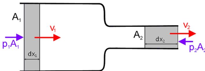
FIGURE 1.10 – Equation de Bernoulli : mise en évidence du travail appliqué lors du passage du système de la section 1 à la section 2.
