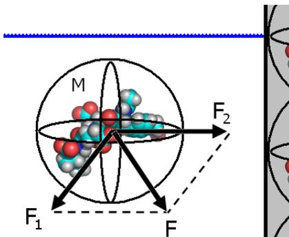
FIGURE 3.2 – Au voisinage de la surface du liquide et de la paroi du récipient, une molécule  $M$  est soumise, par le liquide, à une force  $\vec{F}_1$  et, par les molécules de la paroi du récipient, une force  $F_2$ .
