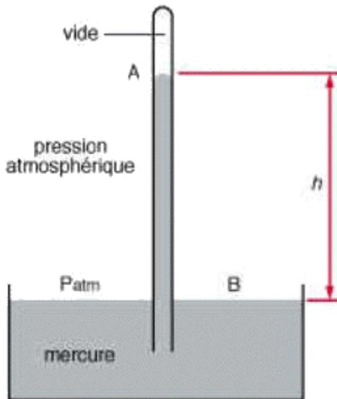
FIGURE 1.14 – Baromètre à colonne de mercure
