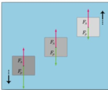
FIGURE 1.2 – Poussée d'Archimède : à gauche,  $\rho > \rho_f$ , au milieu  $\rho = \rho_f$ , à gauche  $\rho < \rho_f$ .
