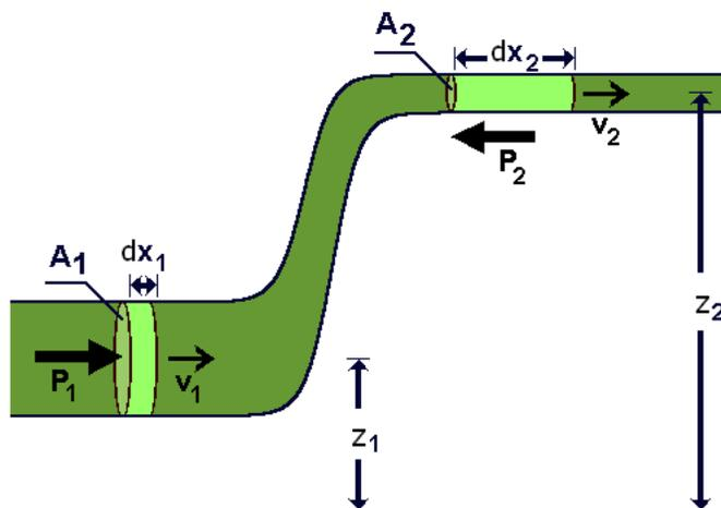
FIGURE 1.11 – Equation de Bernoulli : mise en évidence du travail appliqué lors du passage à des hauteurs différentes.
