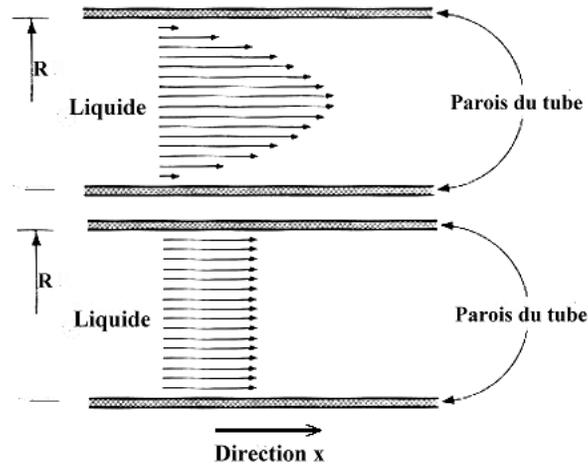
FIGURE 1.7 – Profil de la vitesse : écoulement d'un fluide visqueux (en haut) et non visqueux (en bas)
