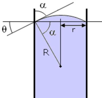
Lorsque la dénivellation  $h$  n'est pas assez grande par rapport au rayon  $r$  du tube, le ménisque s'aplatit et l'erreur sur la hauteur barométrique devient négligeable.
