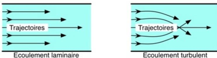
FIGURE 2.3 – Illustration d'un écoulement laminaire et turbulent.
