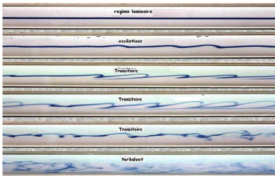
FIGURE 1.8 – Différents types d'écoulements : représentation des lignes de courant.
