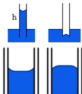
Lorsqu'on utilise des tubes capillaires de sections différentes, on constate que la différence de niveaux entre le liquide du tube et celui du récipient diminue quand le diamètre du tube augmente.
